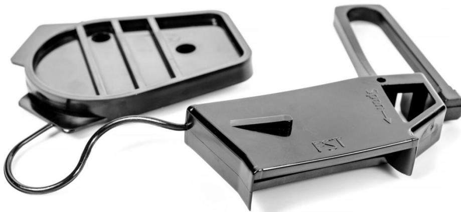
**Описание:** анкерные зажимы FST предназначен для крепления оптических кабелей, внешних патч-кордов, плоского и круглого сечения, медножильных абонентских кабелей. Рекомендованный диаметр (ширина) - до 4мм. Макс. разрушающая нагрузка – > 2кН. Зажим полностью диэлектрический, не содержит металлических элементов в конструкции.
