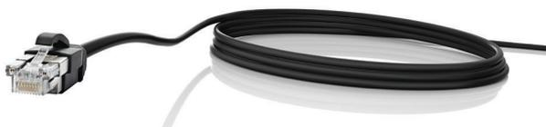
Оба конца системных сетевых кабелей снабжены разъемами, аналогичными разъемам RJ45 с дополнительными контактами питания. Системный сетевой кабель используется для подключения мультимедийного устройства к звуковому процессору или блоку питания. Обеспечивает сетевую связь и передачу питания по одному кабелю. Системные сетевые кабели используются при необходимости сквозных и резервируемых кабельных соединений.
