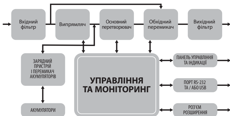
Мал. 1 Блок-схема ДБЖ
