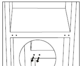
7. Покладіть пристрій тильною стороною на м'яку підкладку. Викрутіть нижній шарнір і регулювальну ніжку
