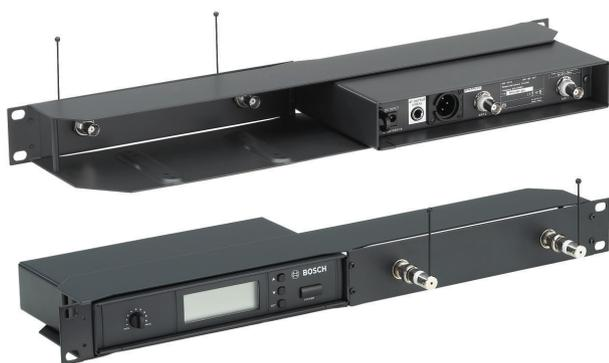
Данный комплект предназначен для установки беспроводных микрофонных приемников MW1-RX-Fx в 19-дюймовую стойку. При помощи этого комплекта можно установить два устройства рядом друг с другом в пространство стойки высотой 1U. Если используется только одно устройство, в другую часть рамы можно установить специальную панель, в которую, в свою очередь, могут быть установлены две антенны. Они подключаются к приемнику при помощи двух кабелей BNC, входящих в комплект.
