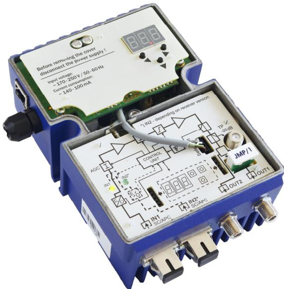
**MOB-729** – это модульный оптический приемник предназначенный для работы в сетях с архитектурой FTTH. Имеет функцию резервирования оптического входа и оснащен электронной регулировкой прямого канала, что позволяет на непрерывную передачу сигнала. Встроенная система АРУ поддерживает постоянным высокий выходной RF сигнал.
